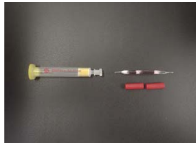
写真は吸引方式用捕集管
