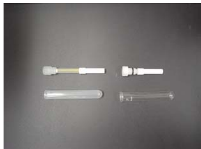
写真は拡散方式用捕集管
