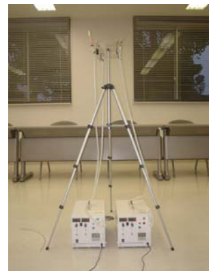
吸引方式による採取状況
