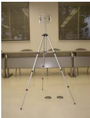
拡散方式による採取状況
